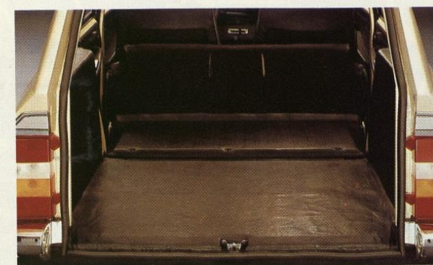
Pour obtenir un plus grand espace, rien de plus simple : la banquette arrière du Break se plie d'un geste et offre ainsi 1,78 m<sup>2</sup> d'une surface plate, à 41,9 cm du sol. L'accès direct au plancher facilite le chargement. La possibilité de varier la garde au sol limite les efforts lors de gros chargements.
