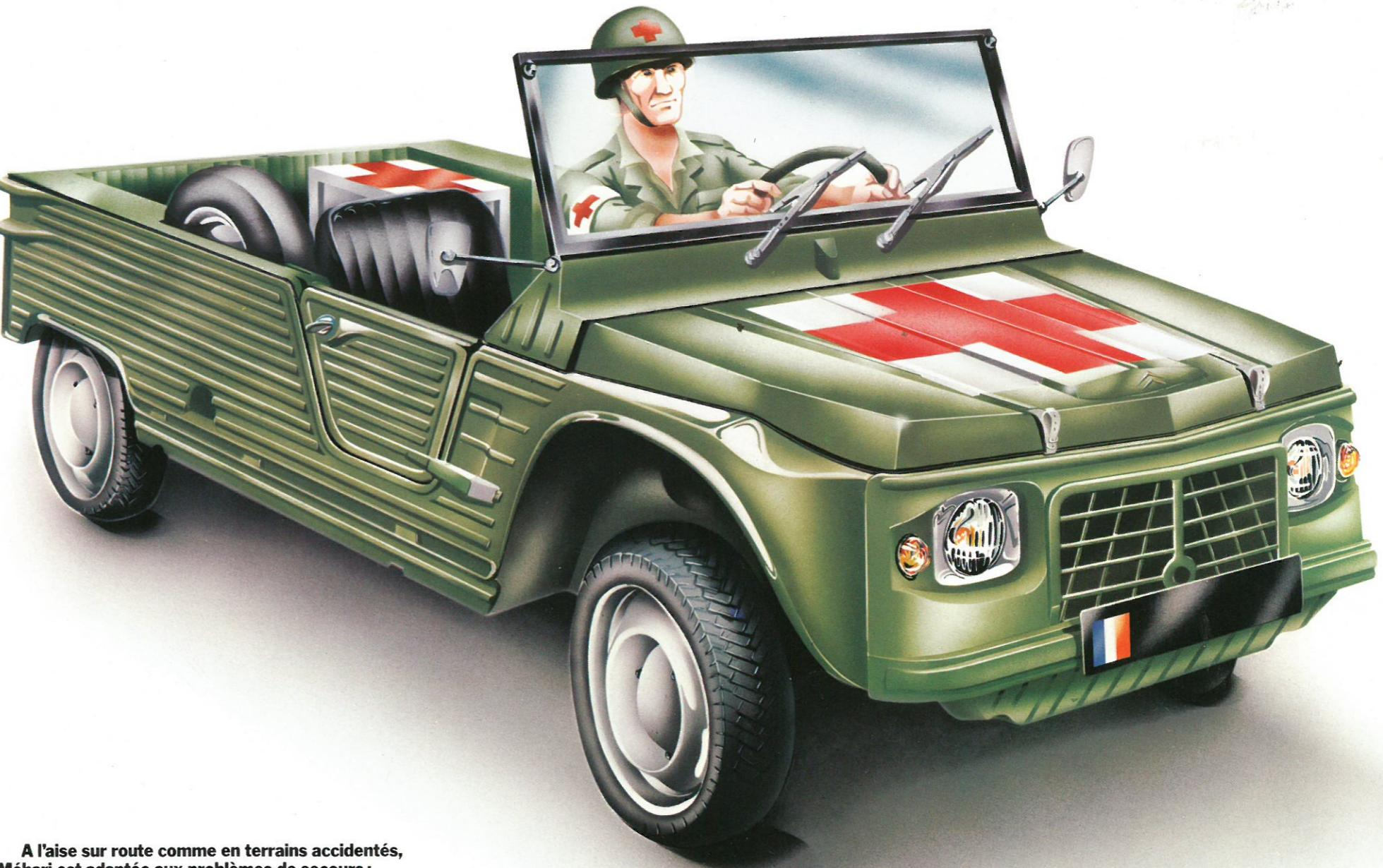
A l'aise sur route comme en terrains accidentés, la Méhari est adaptée aux problèmes de secours : robuste moteur de 602 cm<sup>3</sup> à essence ordinaire et refroidissement par air, autonomie de plus de 300 km et possibilité de placer du matériel de premier secours plus 1 blessé.
